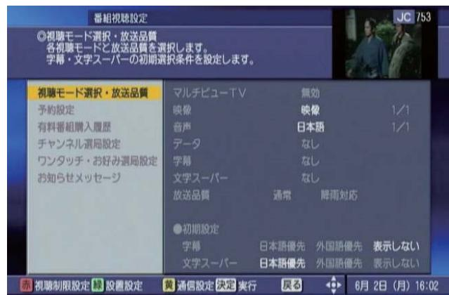
**4 「設置設定」の画面が表示されるので、上下ボタンで「自動チャンネル設定」を選び、決定ボタンを押します。**
