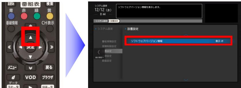
「設置設定」画面で「△」ボタンを一回押すと、画面が切り替わり「ソフトウェアバージョン情報」が選択されます。
